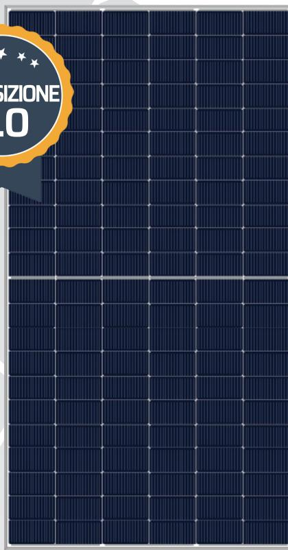
X-HALF CUT N-Type serie TOPCON prevede l'introduzione di un sottile strato di ossido tra i contatti metallici e il wafer di silicio, che apporta significativi miglioramenti nell'efficienza di conversione delle celle e nelle prestazioni di generazione di energia.
